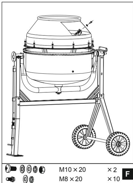
1. Установите верхний барабан на нижний над ободом таким образом, чтобы совместились монтажные отверстия, а также стрелки в обеих частях.
